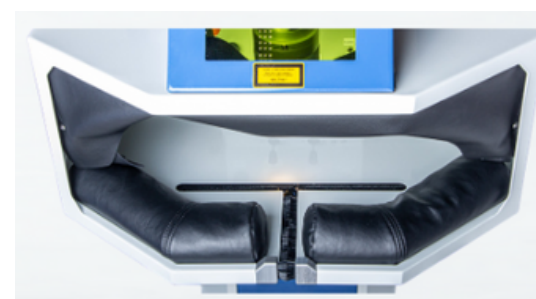
Chambre de travail avec rainure en T
